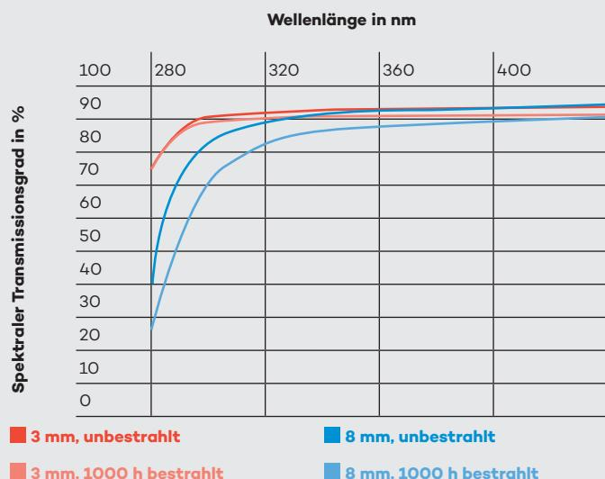
\* Spektraltransmissionskurven von UV-durchlässigem PLEXIGLAS® GS Farblos 2458 SC steht auf Anfrage zur Verfügung.
